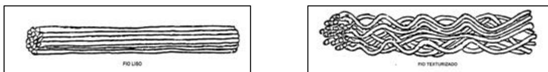
Figura 4.2: Diferença entre os fios lisos (estirado) e texturizado
